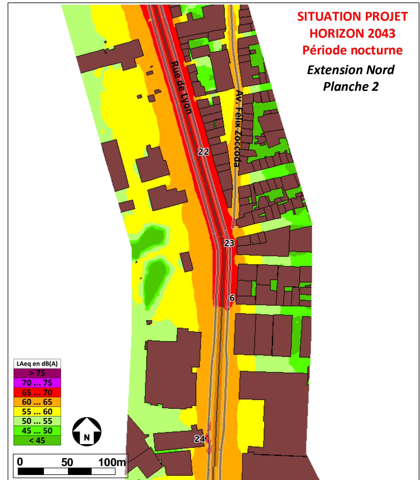
Figure 38 – Niveaux de bruit (h=4 m) en situation projet à l'horizon 2043 – Planche 2 – Période nocturne
