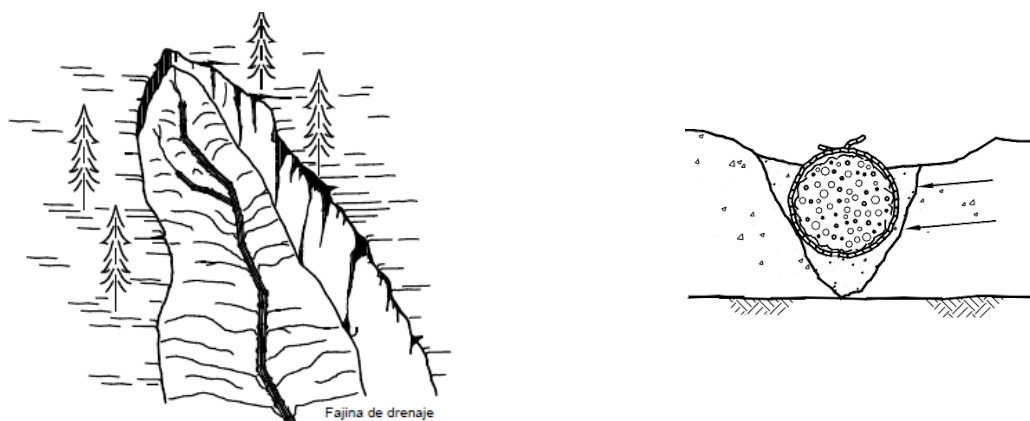
Figura 9: Colocación de fajina de drenaje con suelo en zanja.
