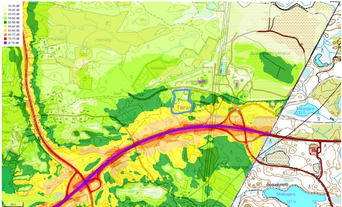
Kuva 11-1. Tampereen kaupungin 2022 meluselvityksen kokonaismelu keskiäänitasolla LAeq päivällä klo 07–22 [dB]. Hankealueen rajaus sinisellä. Lähde: Tampereen kaupunki 2022c.
