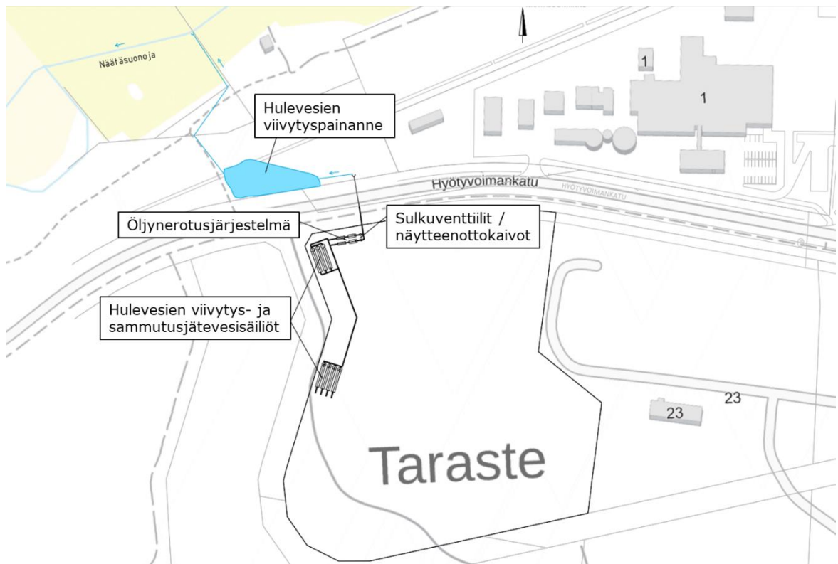
Kuva 3-3. Hulevesien hallintarakenteiden alustava sijoittelu ja purkureitti viivytyspaineen kautta Näätäsuonojaan, laitoksen esisuunnitteluun perustuen.
