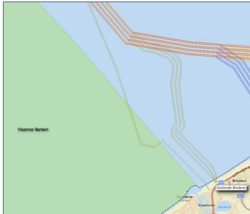
Figuur 3-27: Kabeltraject voor het aanlandingsalternatief Oostende-Bredene ten opzichte van Vlaamse Banken (groen).
