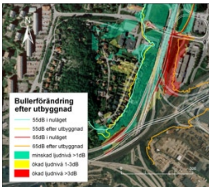
Förändringar i bullernivåer till följd av utbyggnaden. Den framräknade kurvan för 55 dBA är inlagd. 55 dBA är riktvärde för utomhusbuller vid bostäder.
