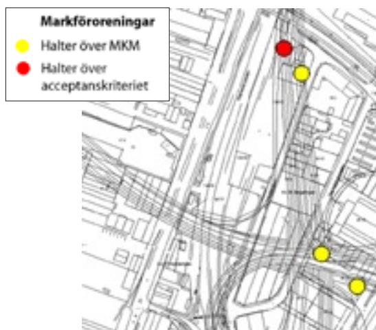
Provtagningspunkter med halter över MKM och acceptanskriterier för deponi klass 2.
