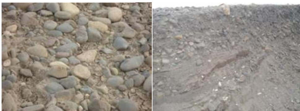
Ilustración No. 11 En la foto de la Izquierda se observa una capa de suelo aluvial superficial compuesto de grava arenoso con contenido de sobre tamaño (boulders) de composición andesita-basalto. Mientras que en la foto de la derecha se observa una graduación invertida (ritmo de suelos arenosos limosos con intercalaciones de grava arenosa y arena gravosas) que es típico de ambientes fluviales con cambios bruscos de régimen turbulento a laminar y viceversa. Ambas fotos fueron tomadas en las coordenadas N1416418/648634.
