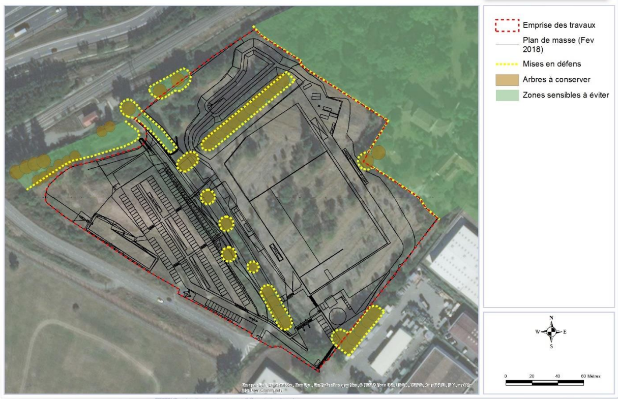
Figure 50 : Zones à mettre en défens avant le démarrage des travaux
