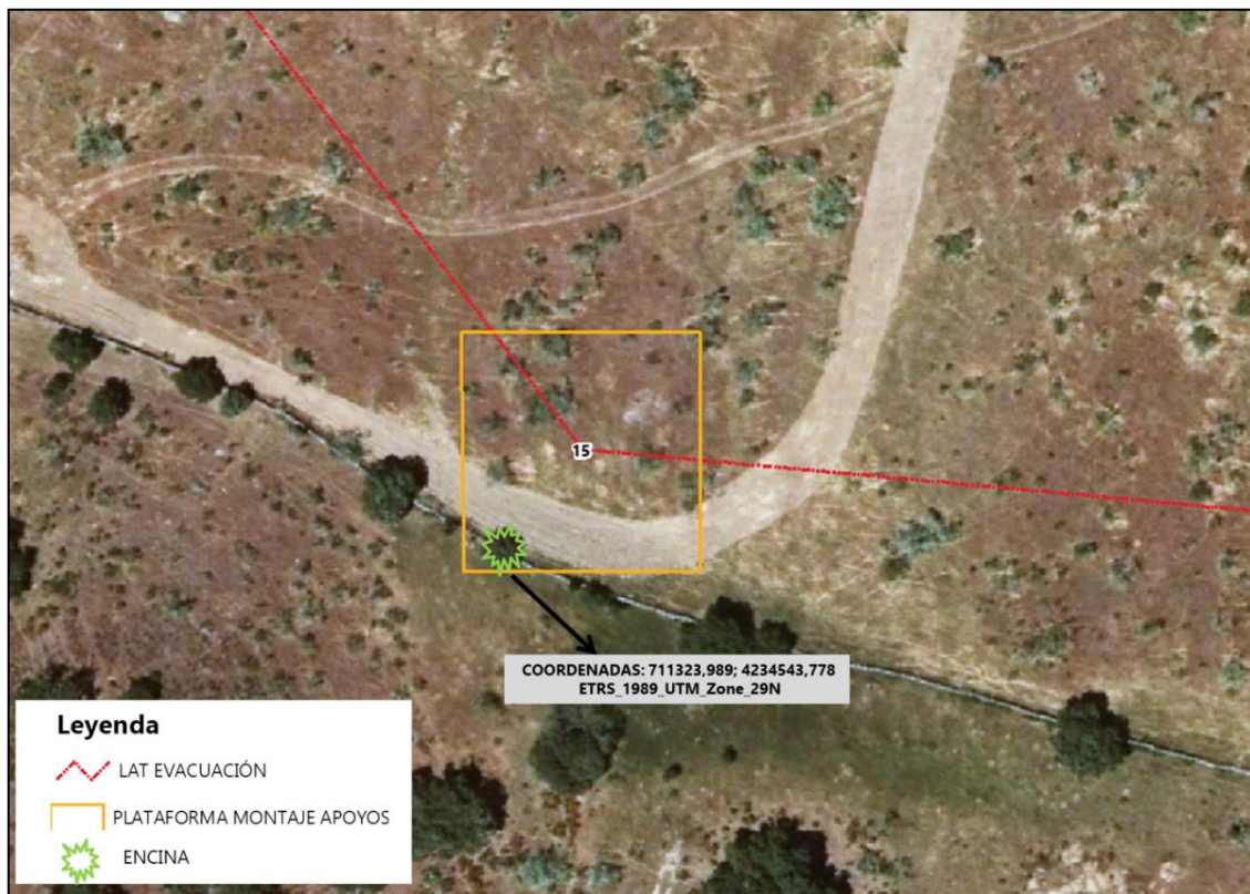
Ilustración 32. Encina localizada en el ángulo inferior izquierdo de la plataforma del apoyo 15, incluida en una parcela distinta a la de localización del apoyo, por lo que lo más práctico es no afectar dicha parcela.
